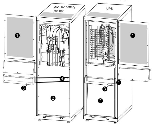
5. Attach conduits to the conduit box.
